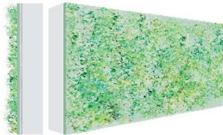
*Fig.2 Schema indicativo di parete verde integrata in aderenza all'involucro con struttura di sostegno*
