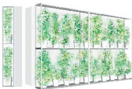
*Fig.4 Schema indicativo di parete verde con messa a dimora delle piante in contenitori: sistema con struttura di sostegno separata dall'involucro.*
