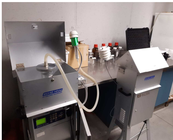
Figura 1 – Campionatori ad alto volume e dettaglio della testa di campionamento
